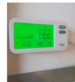
Les capteurs de CO2 (dioxyde de carbone) permettent d'en connaître le taux dans l'air dans une pièce. Le coronavirus se transmettant par le biais de fines gouttelettes diffusées dans l'air, le capteur de CO2 indiquera aux enseignants à quel moment il sera nécessaire d'aérer leur salle de classe. Par ailleurs, le CO2 a des effets néfastes pour la santé comme des difficultés de concentration, de la fatigue, des maux de tête, difficultés de concentration ...
